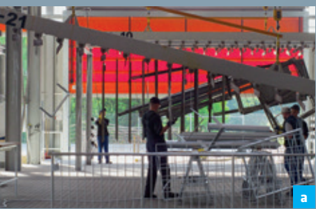
a b c Dílce jsou upevněny pomocí vázacích drátů nebo speciálních přípravků, menší dílce mohou být zavěšeny i přímo na háčky.
