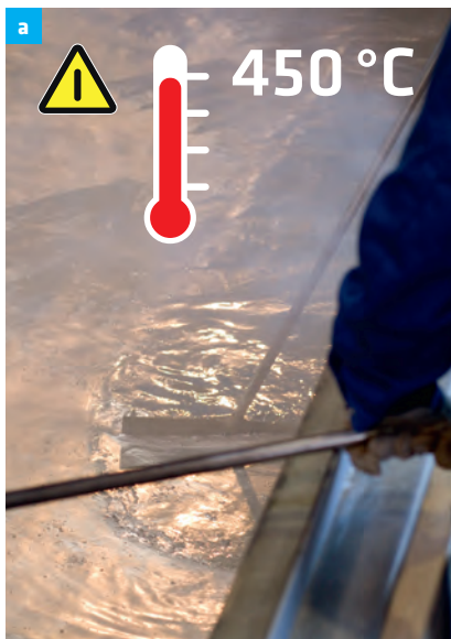
a Zwischen der ursprünglichen Temperatur der Werkstücke und der Temperatur des Zinkbades besteht eine beträchtliche Differenz.
