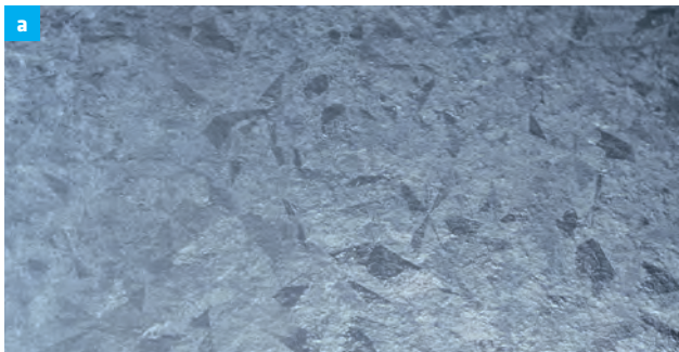
a Stahl im Niedersilizium-Bereich
