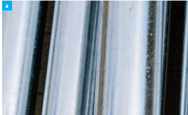
a Eine Nachbehandlung der Werkstücke durch Konservierung oder Passivierung erhält den Glanz und schützt vor Weißrost.
