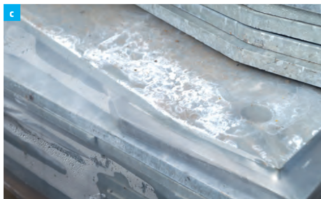
b Weißrostbildung auf feuerverzinktem Werkstück
