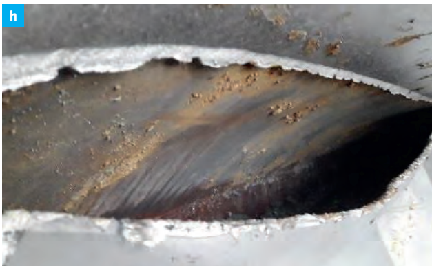
d Zinkausschleppung in offenen Profilen
