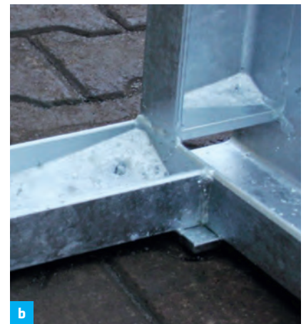
b Werkstück mit nicht abgelaufenem und daher im Inneren des Profiles erstarrtem Zink (Zinkausschleppung).
