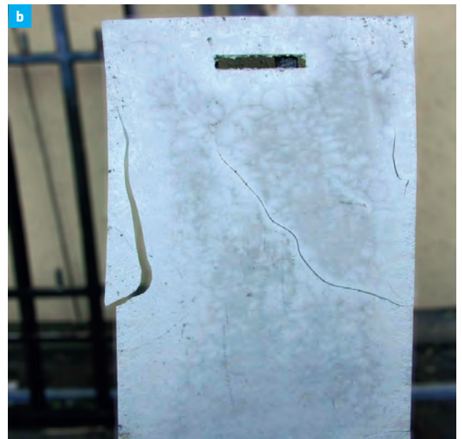
b Werkstück aus massivem Stahlguss mit zahlreichen Rissen nach dem Feuerverzinken
