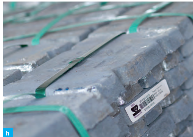
h Zinkbarren zur Beschickung des Verzinkungskessels.
