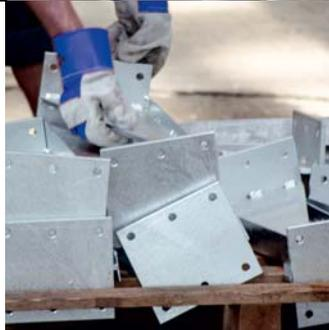
**Und wieder Handarbeit:** An der Abrüststation werden die Stahlbauteile abgehängt, gewogen, auf Vollzähligkeit geprüft und anhand der Auftragsunterlagen wieder zu kompletten Lieferungen zusammengestellt. Menge, Gewicht und Qualität werden dokumentiert.
