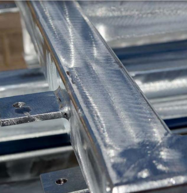
**Eine metallisch blanke Oberfläche:** Das ist die Voraussetzung für eine qualitätsgerechte Feuerverzinkung. Dazu wird bei Wiegel eine nasschemische Oberflächenvorbehandlung durchgeführt.
