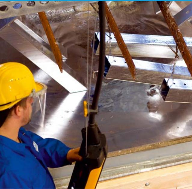
**Von Hand gesteuert** wird das vorbehandelte Material an der Traverse in das Herzstück der Verzinkungsanlage, den komplett eingehausten Verzinkungskessel mit schmelzflüssigem Zink, eingefahren.
