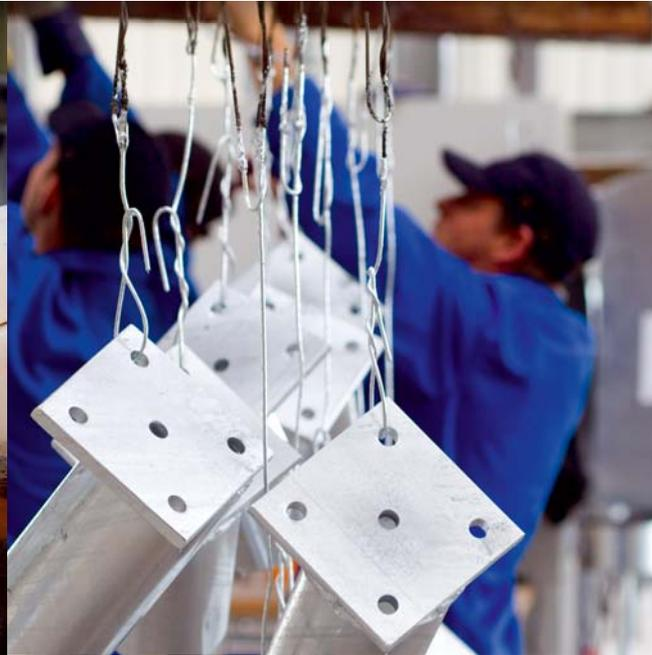
**Abkühlen:** Je nach Erfordernis und Beschaffenheit der Stahlkonstruktion lässt man das Verzinkungsgut an der Luft abkühlen oder kühlt es im Wasserbad ab.
