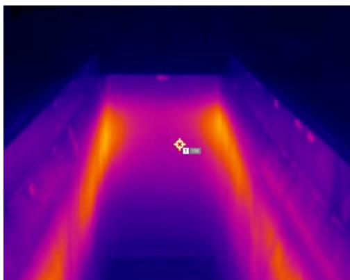
Teplo ze zde vzniklé tepelné energie se následně přenáší sáláním na stěnu vany.
