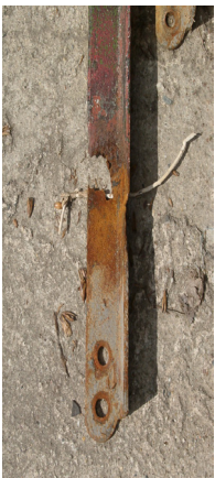
Unverzinkte Gittermastteile nach 30 - 40 Jahren
