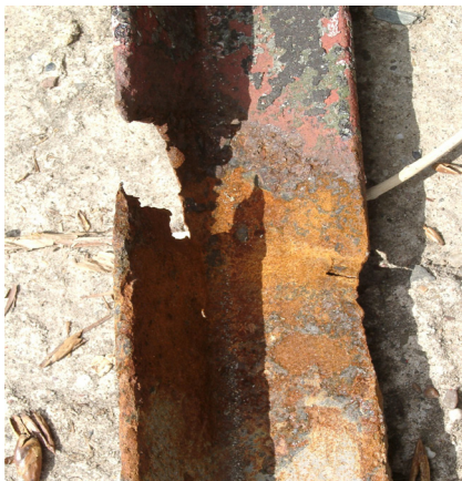
Unverzinkte Gittermastteile nach 30 - 40 Jahren
