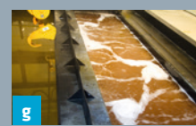
f Das Flussmittelbad dient zur Erhöhung der Benetzungsfähigkeit beim Verzinken.
