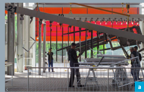
a b c Die Werkstücke werden mittels Bindedraht aufgebunden, geeignete kleinere Teile können auch direkt an Hakenbühnen aufgehängt werden.
