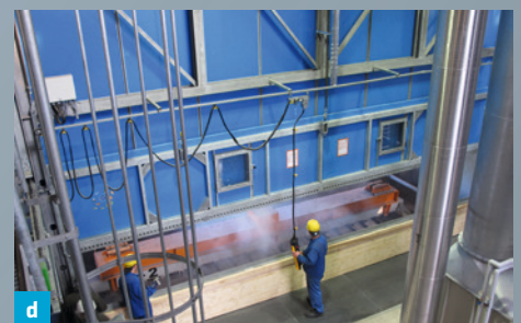
d Die Einhausung des Verzinkungskessels wird nur zur Entnahme und Kontrolle der Werkstücke geöffnet. Geeignet angebrachte Absaugeinrichtungen sorgen dafür, dass die Abluft kontrolliert erfasst und über die Filteranlage gereinigt wird.
