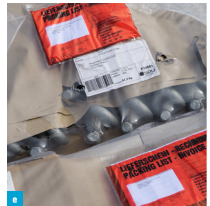
d e Eine CE-Kennzeichnung kann und muss durch den Hersteller – nicht durch den Feuerverzinker – am Bauteil selbst oder auf den Begleitpapieren z.B. als Anlage zum Lieferschein erfolgen.
