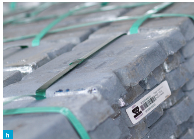
h Zinkbarren zur Beschickung des Verzinkungskessels.
