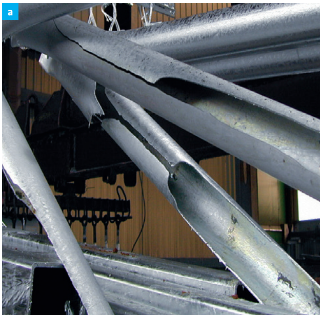
a Gerissene Rohrprofile aus Feinkornbaustahl
